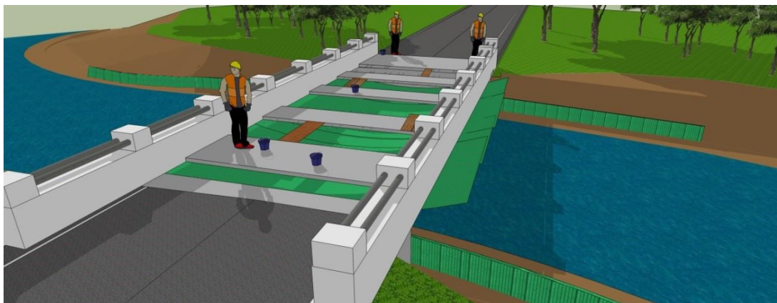
รูปที่ 6.2-5 ตัวอย่างการติดตั้งตาข่ายใต้โครงสร้างสะพานเพื่อป้องกันเศษวัสดุตกลง <<กลับไปยังสารบัญ
